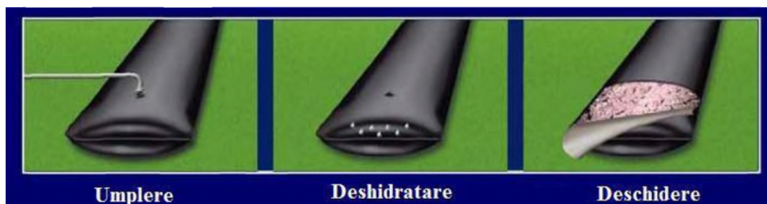
Figura 1. Principiul de deshidratare în Geotube
