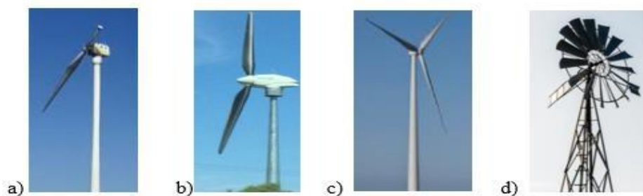
Figura 1. Tipuri de turbine eoliene cu axă de rotație orizontală (HAWT) cu număr diferit de pale. a) cu o singură pală; b) cu două pale; c) cu trei pale d) cu mai multe pale
